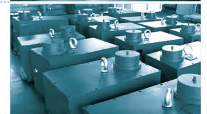
立车升降箱——丝杆升降机在机床上的典型应用：配Tr8010丝杆，提升重量250KN，成对使用，要求严格同步
