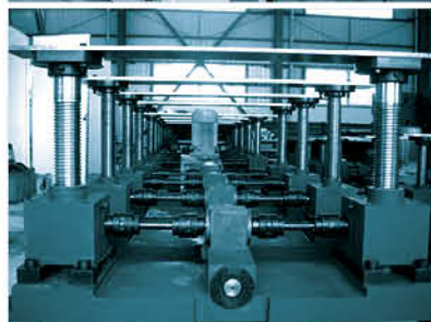
升降机在大型水利试验台上应用：50米长变坡水槽，用升降机实现坡度精确调整
